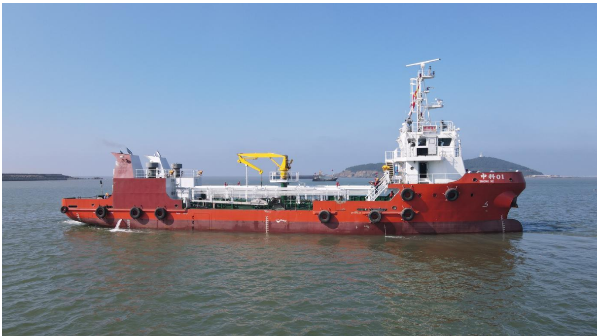
图 2.8-34 中科炼化码头区域配置溢油回收船“中科 01”
