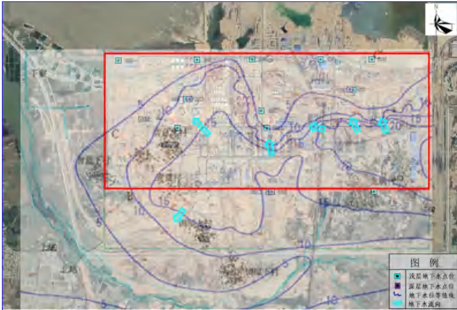
图 2.7-3 初步调查地下水采样布点图（2020 年）
